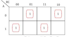
DIFFERENCE =  $(\overline{A}.\overline{B}.C + A.\overline{B}.\overline{C} + \overline{A}.B.\overline{C} + A.B.C)$
